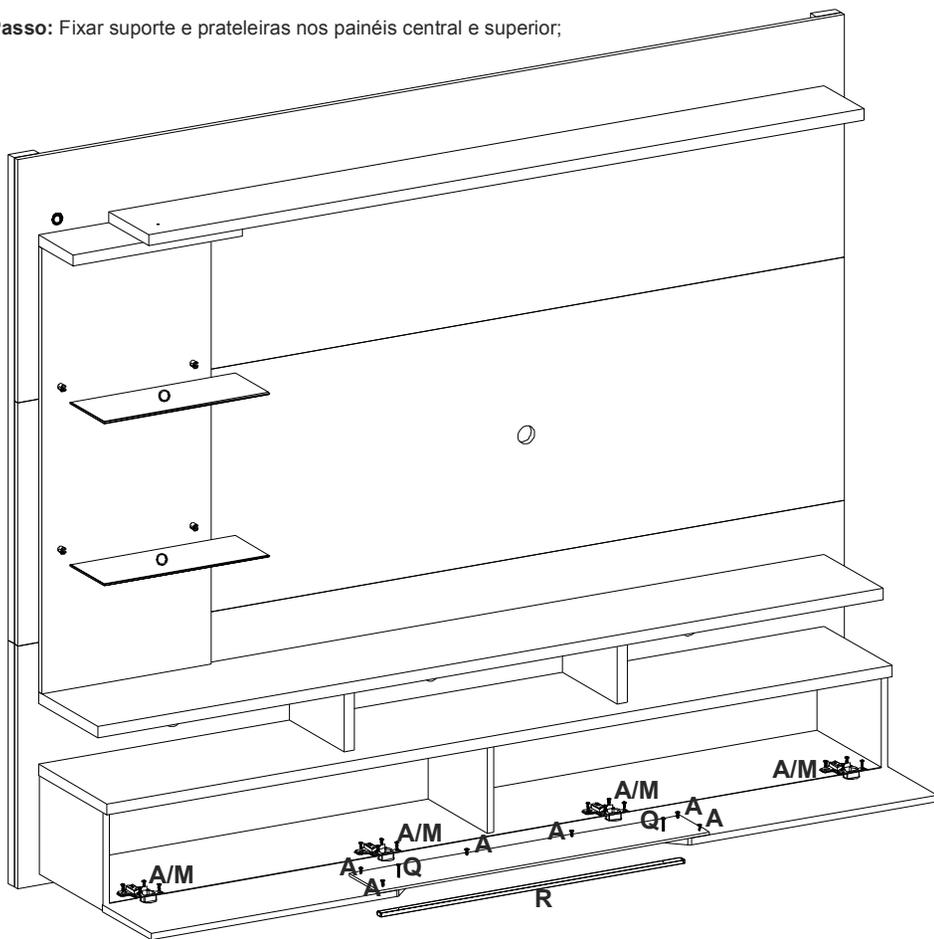
**ATENÇÃO:** Após pendurar o painel observar que no painel inferior existem dois furos para fixar o parafuso letra **T**, na parede, na bucha letra **N**. Marcar a posição dos furos, retirar o painel da parede, furar, colocar a bucha, pendurar o painel e fixar o parafuso **T**.
