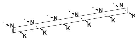
**IMPORTANTE: É OBRIGATÓRIO A FIXAÇÃO DAS DOZE (12) BUCHAS DE PAREDE COM OS PARAFUSOS CONFORME O DESENHO AO LADO**
