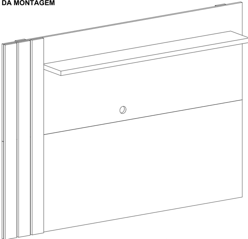
9º - Fixe o painel na parede encaixado-o no suporte.
