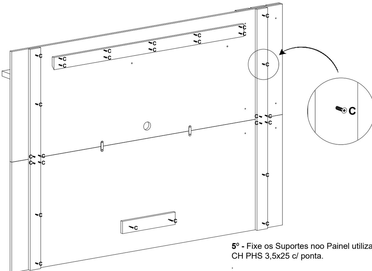
5º - Fixe os Suportes no Painel utilizando o Parafuso CH PHS 3,5x25 c/ ponta.
