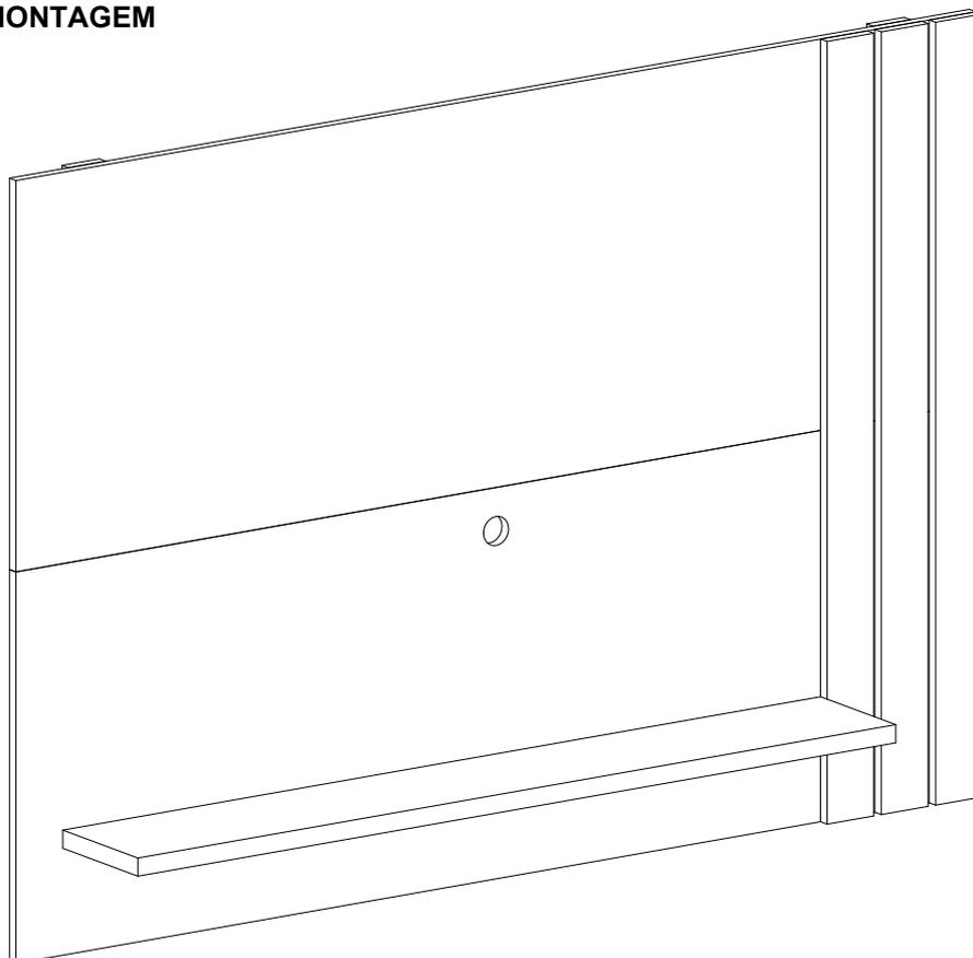
5º - Fixe o painel na parede encaixado-o no suporte.
