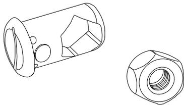
6º - Encaixe as buchas com as porcas nas furações da grade fixa, de modo que no momento da montagem o parafuso entre pelo lado contrário da porca, conforme desenho abaixo:
