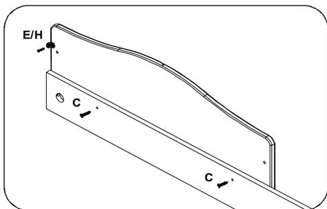
6° - Trave a barra nos painéis conforme a imagem ao lado utilizando o parafuso TP 10 SXINT 1/4"x60 s/ ponta fixando-o no anel fixador 25x11mm com porca quadrada de 1/4", usando cavilha 6x30 como guia da peça.
