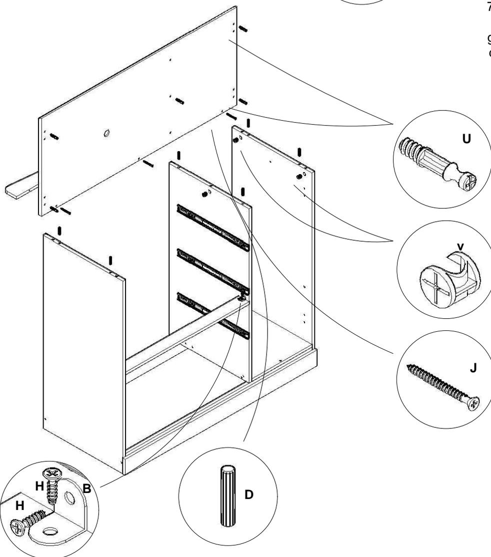
8° - Fixar tampo com parafuso minifix letra U, tambor minifix letra V e cavilha 6x30 letra D. Fixar moldura no tampo com parafuso 3x5x45 letra J.
